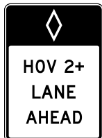
איור 2.6: סימן נתיב שמור בדוגמה זז, הנתיב שמור לרכבים בעלי תפוסה גבוהה (HOV) הנושאים שני אנשים או יותר.
