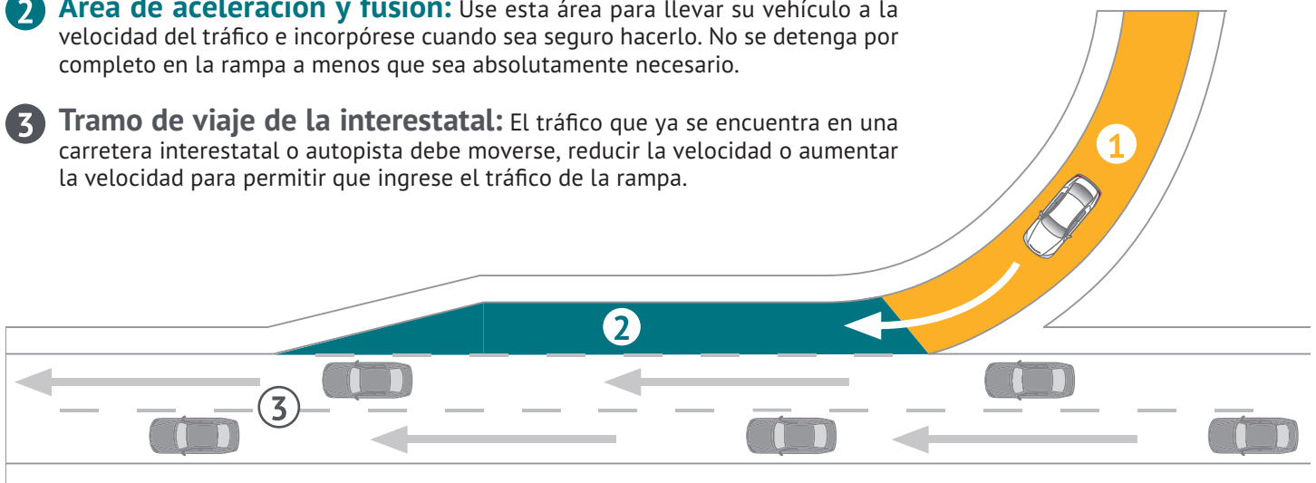
Imagen 5.2: Segmentos de rampa
