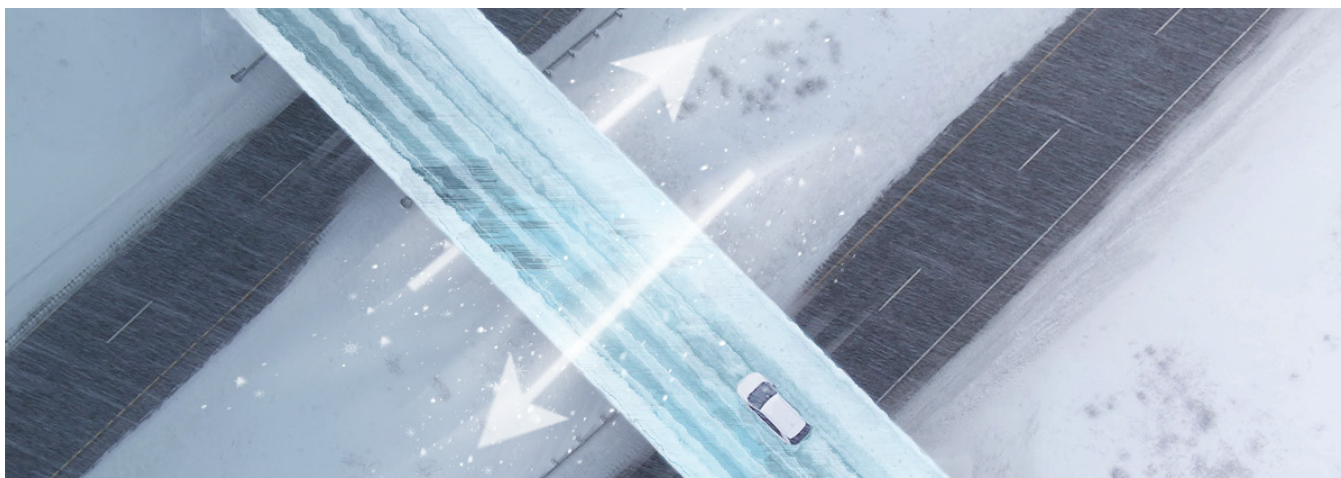
Рисунок 5.9: Лед образуется на мостах в первую очередь из-за циркулирующего воздуха как над, так и под поверхностью дороги.
