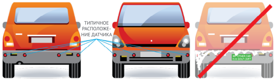
Датчики необходимо содержать в чистоте, чтобы они функционировали должным образом.
