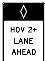
Рисунок 2.6: Знак зарезервированной полосы В этом примере полоса зарезервирована для транспортных средств с высокой вместимостью (ТСВВ), перевозящих двух или более человек.
