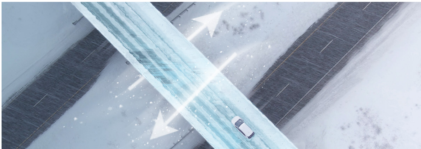
Illustration 5.9 : La glace se forme d'abord sur les ponts en raison de la circulation de l'air au-dessus et au-dessous de la surface de la route.
