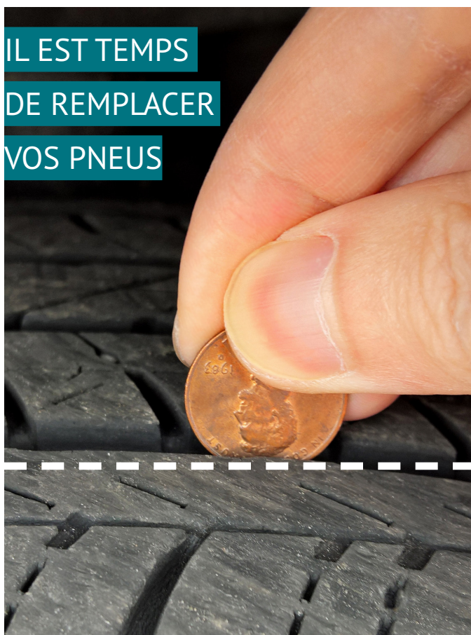
Illustration 3.1 : Vérifiez la bande de roulement de vos pneus avec un centime
